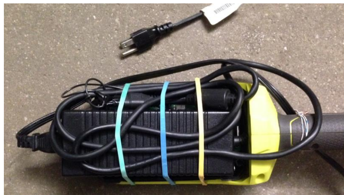
图 9. 临时捆绑开关电源到原来的锂电池插座
