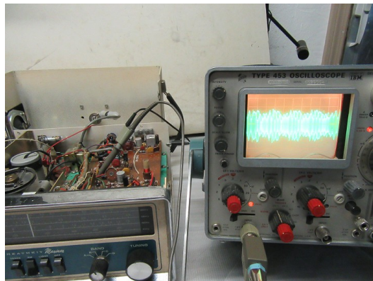
图 10. 第二中放輸出的中频信号, 1Vpp
