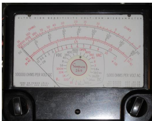
Fig. 3 動態顯示量程範圍的萬用表
