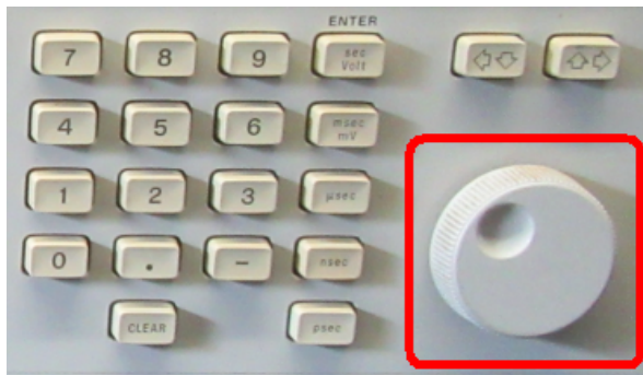
图 16. 转动圆的旋钮调节扫描速度
