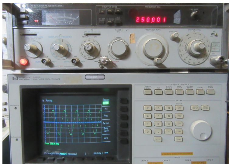
图 22. 把 HP 8640B 调到频率=250MHz, 输出电压=2.0Vpp
