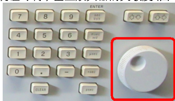
图 13. 转动圆的旋钮调节垂直放大器的灵敏度
