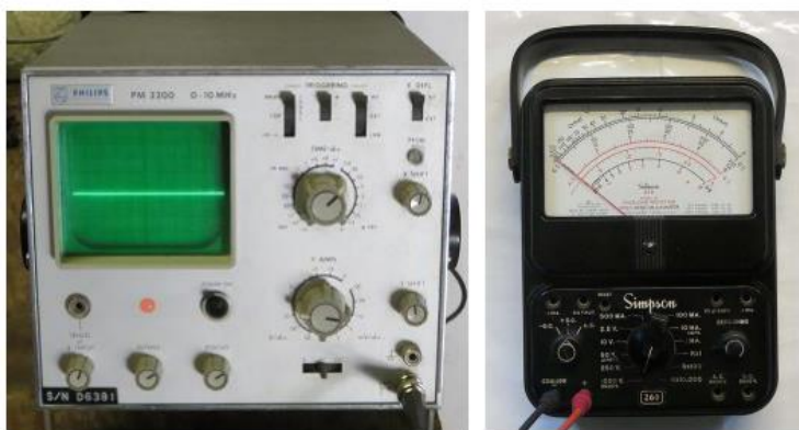
图 14. 修理用仪器。示波器和万用电表
