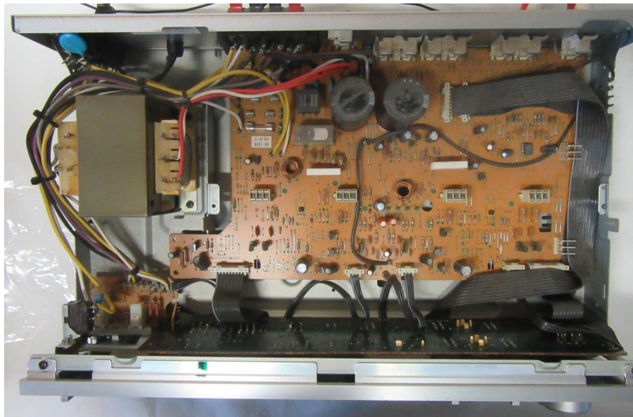
图 7. 取下铝制的散热器，印刷板上大部份零件都可触及了
