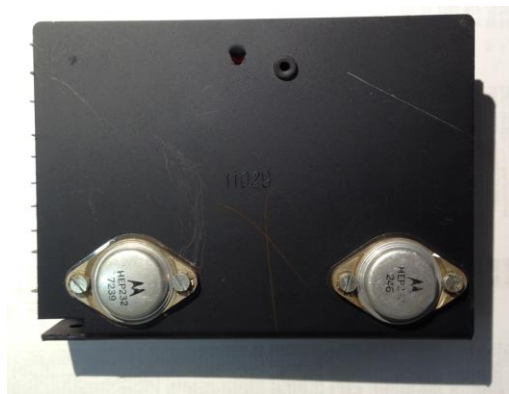
图8. 大功率管Q305, Q306及散热器焊接在功放印刷版的背面
