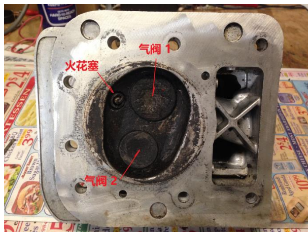
图11. 引擎的前半部有火花塞和2气阀
