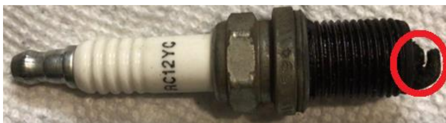
图4. 火花端的两边都已经发黑而且有很厚的氧化物
