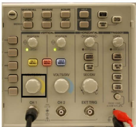
圖 4：縮放 Y 軸的\ VOLTS / DIV 旋鈕。
