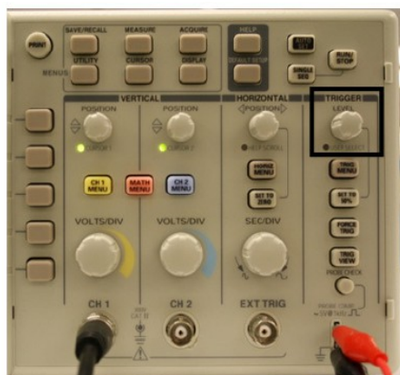
圖 7：\ LEVEL“旋鈕設置觸發電平。
