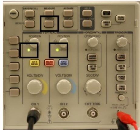
圖 9：“CURSOR”按鈕切換光標模式。當 LED 亮起時，表示您處於光標模式，而 POSITION 旋鈕現在控制光標。
