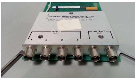
图 9. 7158 插件输入(1-4)和输出
