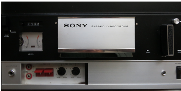
图 9. 向上提可打开磁头防尘盖
