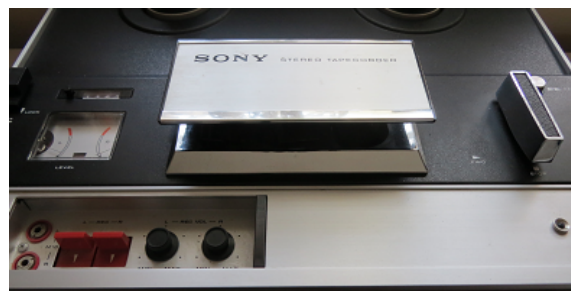
图 9. 向上提可打开磁头防尘盖
