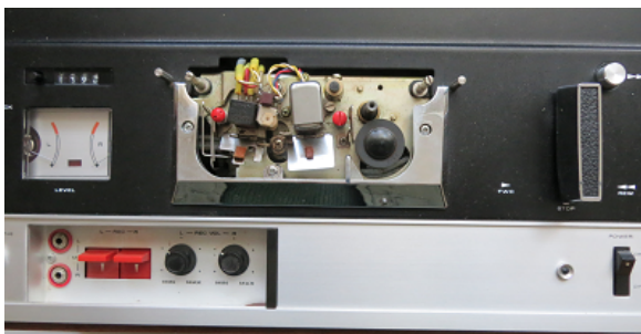
图 10. 打开磁头防尘盖可见橡皮主靠轮
