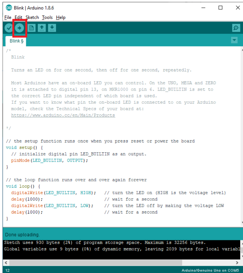
图5. Blink 程序. 按Load(红框)就可编译, 运行
