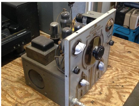
图 2. A 段 X10 (500Kc-1.7MC) 频段接上天线用作广播收音机
