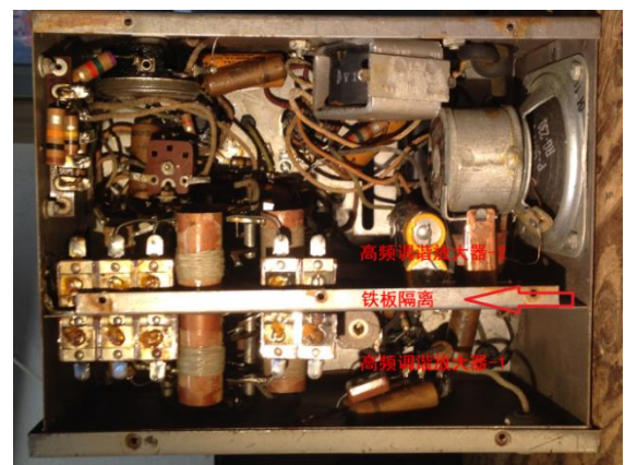
图 2. 两极调谐高放之间用铁板隔离
