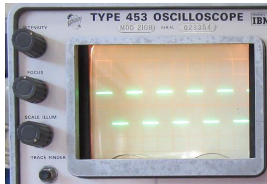
圖 10 第一部份：示波管控制部分
