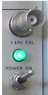
圖 3 电源开关和校正信號源 (1kHz CAL)
