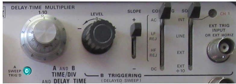
圖 12 第三部分: B 触发部分
