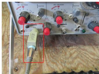
圖 8 示波器的信號輸入端(通道 1)
