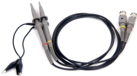
圖 4 示波器的輸入探头
