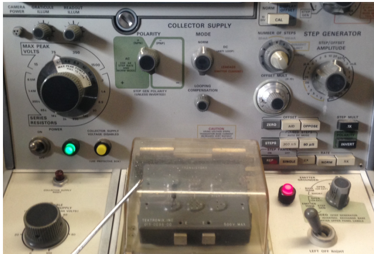
图 12. 测量高压的保护系统 - 高压保护塑料罩
