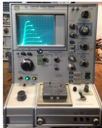
图 2. 我的 Tek576 修复后的照片
