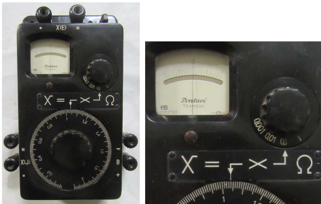
图 8. Pontavi 电桥是一种专测极低电阻的电桥
