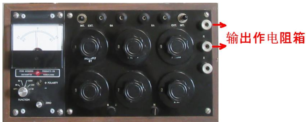
图 9. R 的两个接线端子可以输出用作电阻箱
