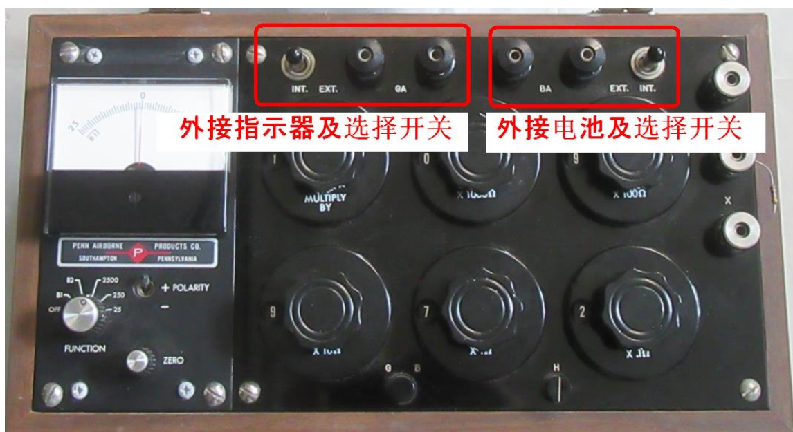
图 12. 如何外接指示器和外接高压电池
