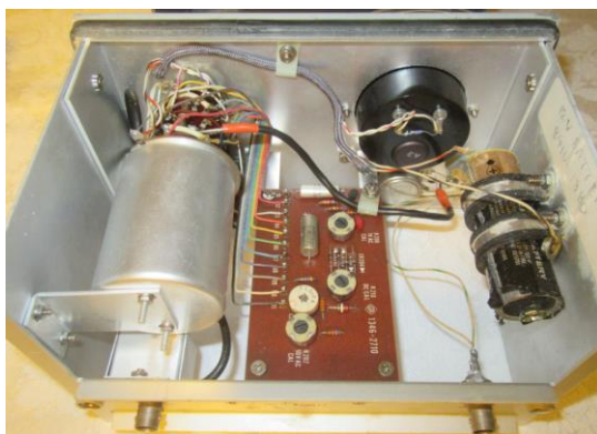
图 17. 调节印刷板电路上的电阻 R202
