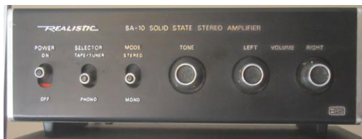
图 5. 10 W 音频放大器 REALISTIC SA-10
