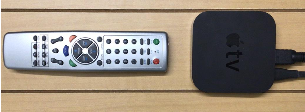
Fig. 11 自制遥控器：把遥控器红外发射管对准Apple TV前的IR接收点
